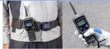
Il **GX-Force** è il nuovo rilevatore 4-gas di Riken Keiki, dalle dimensioni ridotte, con pompa di aspirazione integrata e batteria al litio con autonomia di 30 ore. **Con sensori garantiti 3 anni**, offre la massima affidabilità e praticità di utilizzo.
