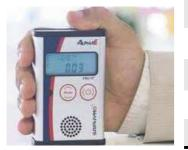
Rivelatore: camera di diffusione con diodo al silicio
