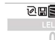
L'icona del Datalog viene visualizzata durante il datalog istantaneo
