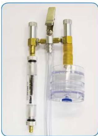
Mod. con ingresso dal basso cod. 505396 Esempio di configurazione con 1 portafiala e 1 filtro a cassetta
