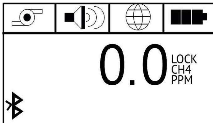
Quando la concentrazione torna al di sotto dello 0,1% VOL, il LED blu rimarrà acceso per indicare che METREX rimane in modalità %VOL. Per tornare alla modalità ppm, premere il tasto freccia giù / 0 quando la concentrazione è inferiore all'1,0%
