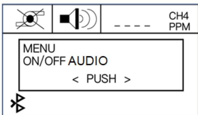
L'allarme acustico può essere attivato o disattivato utilizzando l'opzione di menu AUDIO ON / OFF e premendo il pulsante "OK". Quando l'allarme è disabilitato, l'icona dell'allarme è barrata da una croce. Quando la concentrazione di gas misurata ha superato la soglia di allarme, i LED rossi lampeggiano, questo sarà il caso anche con l'allarme acustico disattivato. (Vedere foto a lato).
